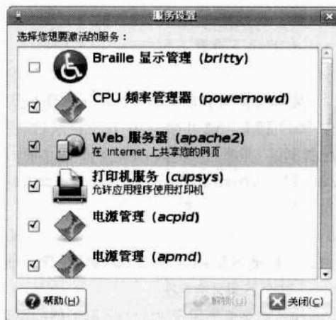
图 21.3 使用服务设置工具管理 Apache2 服务器
