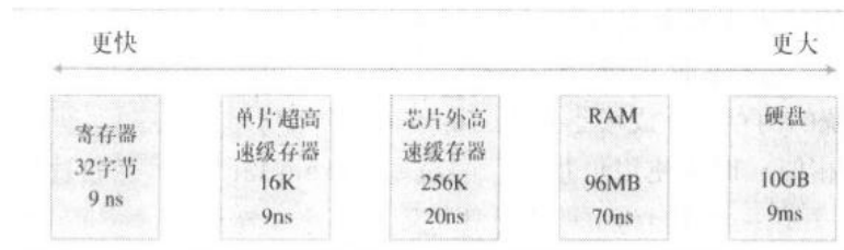
图8-1 具有不同速度和容量的不同级别的存储器
