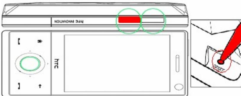
Para poner la pda en modo bootloader tenemos que apretar las teclas marcadas en **rojo**(bajar volumen + reset) y debe aparecer la pantalla tricolor.
