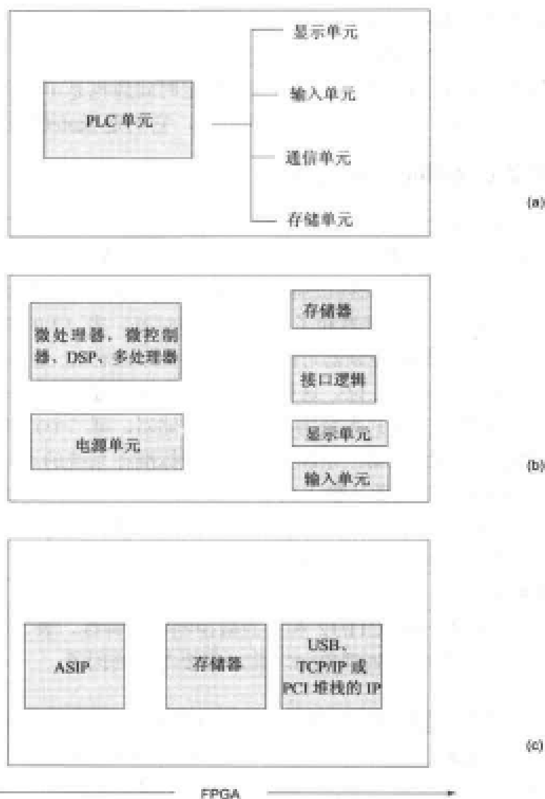
图 12-7 (a)使用 PLC 代替处理器; (b)使用微处理器、微控制器或者 DSP; (c)使用嵌入到 FPGA 中的 IP 来代替 ALU 进行函数处理
