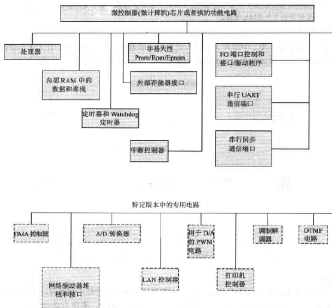
图 1-2 嵌入式系统中的微控制器芯片和核中的各种功能电路(实线框中的部分), 以及微控制器系统的特定版本的专用单元(虚线框中的部分)
