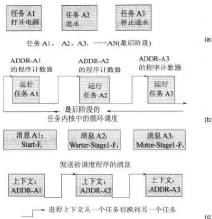
图 9-1 (a)文中示例的嵌入式软件划分的任务组 A1 到 AN 中的前三个任务；(b)循环调度；(c)不同时刻来自调度程序和任务程序上下文的消息
