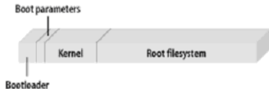
图1 固态存储设备的典型空间分配结构
